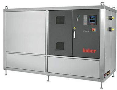
Термостат может охлаждать теплоноситель до отрицательных температур за счет встроенного контура охлаждения, использующего натуральный хладагент. Сама система рефрижерации имеет воздушное охлаждение. Насос и детали, контактирующие с влагой, выполнены из нержавеющей стали и высокопрочной пластмассы. Имеется система защиты от перегрева теплоносителя согласно DIN 12876.
